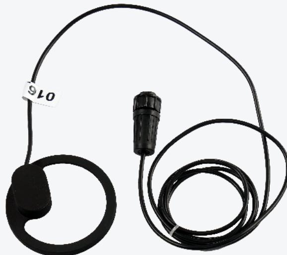
Індуктивний сенсор призначений для передавання даних з аналогових водомірів на Імпульсний радіомодуль Jooby OMNI RM LoRaWAN 4PU 200 / 204 / 205 EU. Пристрій монтується на корпус приладу обліку та підключається до радіомодуля. Після цього Сенсор починає фіксувати кількість обертів вимірювальної стрілки лічильника води та передавати дані Імпульсному радіомодулю.
